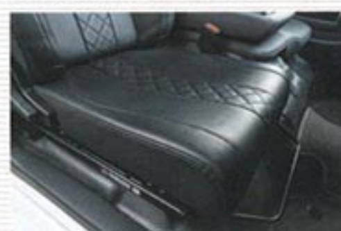
トラックならではの乗降動作を考えたフラットな座面形状。椅子に座ったような姿勢がとれる設計となっている。座面高は純正比0~1cmアップ。
