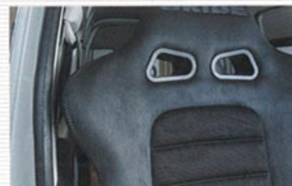
ショルダーを張り出してホールド性を高めた形状。写真はワイドボディのピラーとのクリアランス。
