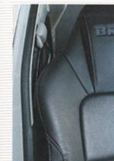
ショルダー部分がピラーに干渉しないようにショルダー幅を495mmとコンパクトにしている。写真はナローボディとのマッチング。高くする。
