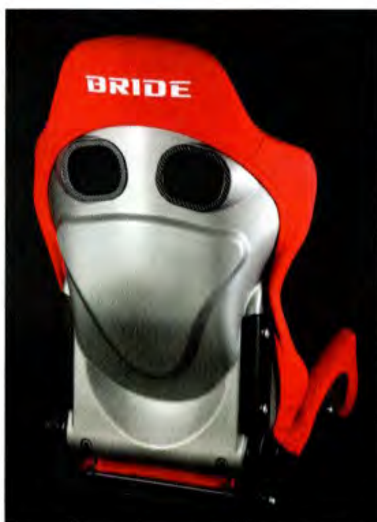
高剛性のモノコックシェルを採用しているガイアスIII。プロトタイプは、FRP製シルバースhellとなっていた
