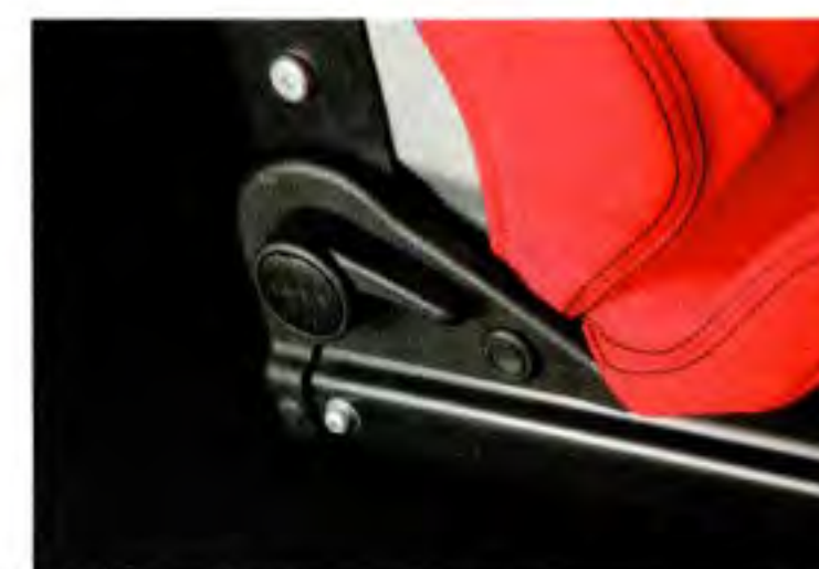
新開発されたリクライニング機構は、角度調節もレバーのワンタッチ操作で可能にする。後席への乗降もラクだ
