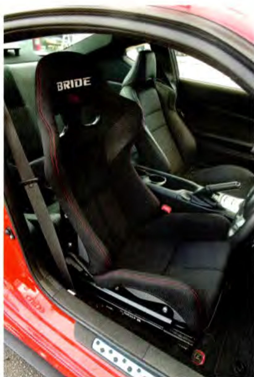
高剛性のモノコックシェルを採用しているガイアスIII。プロトタイプは、FRP製シルバースhellとなっていた
