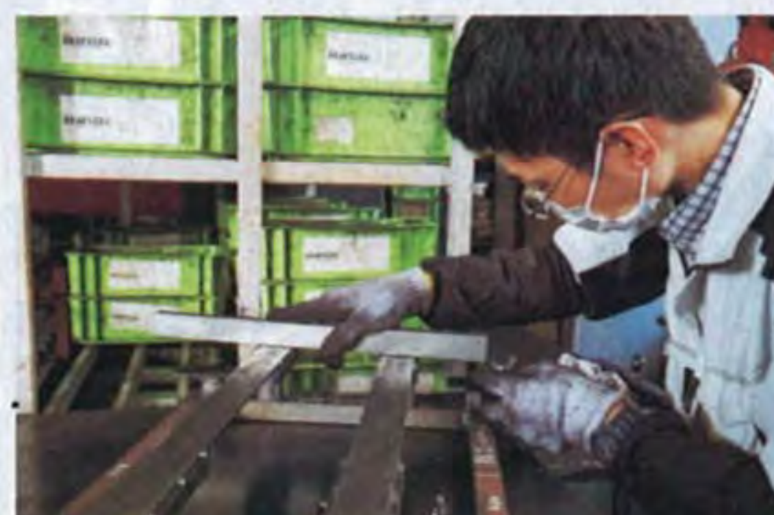
シートレールも手作りで仕上げていく。シートレールの型は1000種類もあるというから驚きだ
