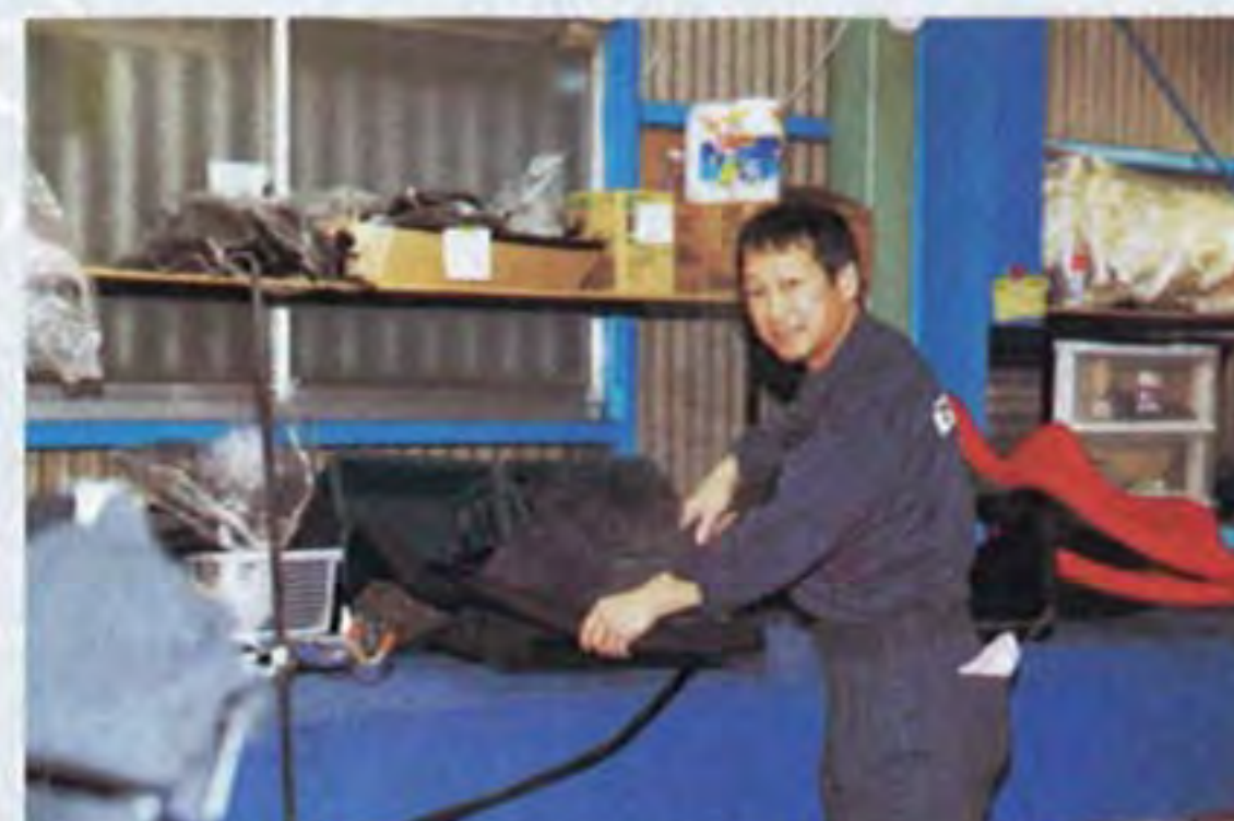
シート素材とクッション素材をシェルに組み込む際には、スチームでしっかりと合わせていく
