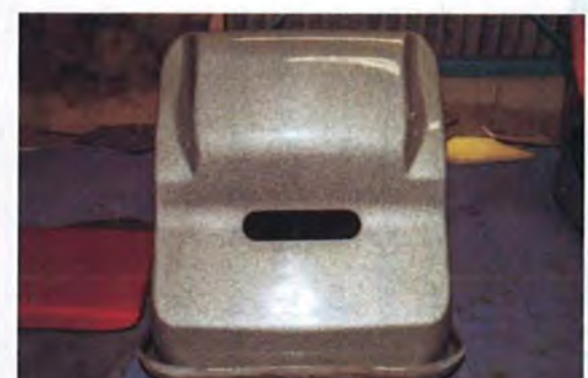
1mmでも低いポジションを得るため最新モデル用にシートレールの幅をえぐったシェルを開発
