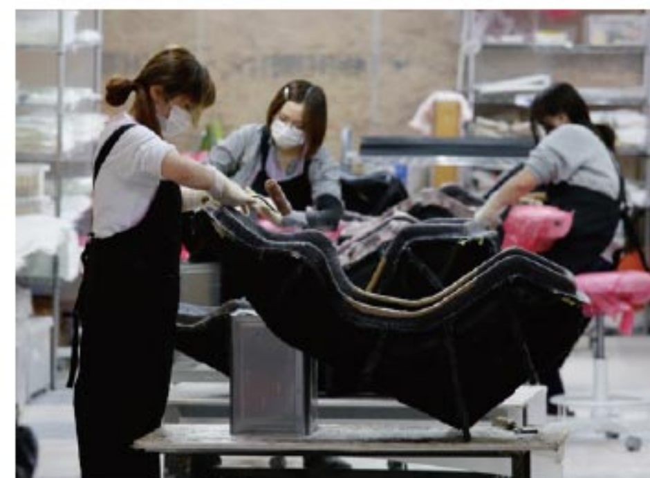
シェルの製作では、強度を確保するため樹脂の肉厚を均一に塗る技術が必要となる。
